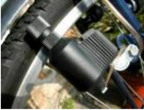
La dynamo d'une bicyclette est en fait une petite génératrice. Elle contient un aimant entouré d'un enroulement en cuivre.
