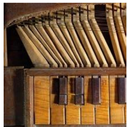
Détails du mécanisme d'un clavicorde
